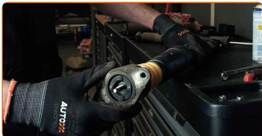
**19** Stram tårnmøtrikken på støddæmperen. Brug en kombinøgle N°13. Brug en støddæmper modhold topnøgle N°DD6. Brug en momentnøgle. Stram den til 25 Nm moment.
