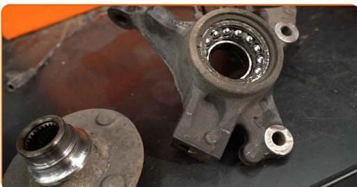
**37** Rengør hjulnavet lejets låsering. Brug en stålbørste. Brug WD-40 spray.
