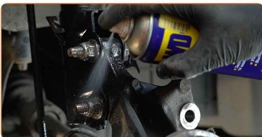
**20** Løsen den nedre befæstelse der forbinder fjederbenet til stubakslen. Brug en kombinøgle N° 15. Brug en topnøgle N°18. Brug en skraldenøgle.
