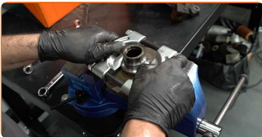
**36** Træk den indre lejeskål ud af hjulnavet. Brug en lejeaftrækker. Brug en drivdorn. Brug en hammer.
