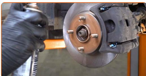
**73** Rengør bremsekivens overflade. Brug bremserens.
