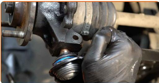
**54** Rengør montagestedet til styrekuglen. Brug en stålbørste. Brug WD-40 spray.
