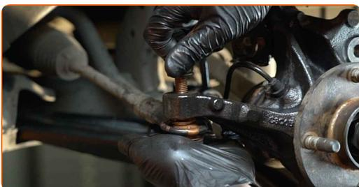
**56** Skru befæstigelses møtrikken ind som forbinder styrekuglen med styrespindel. Brug en topnøgle №18. Brug en skraldenøgle.
