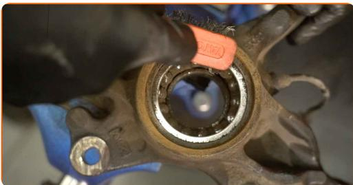
**38** Fjern hjulnav lejets låsering. Brug låseringtænger. Brug en skruetrækker med lige kærv.
