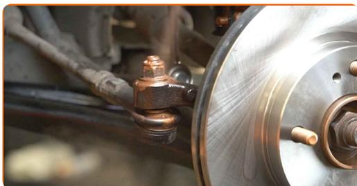
**72** Behandle overfladen hvor bremsekiven har kontaktflade til hjulnavet. Brug kobberfedt.
