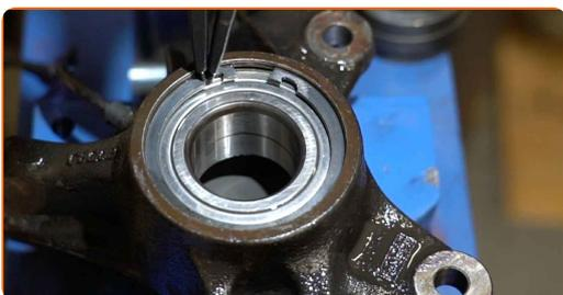
**45** Monter hjulnavet på styrekuglen. Brug et bøsnings- og lejeaftrækkersæt.
