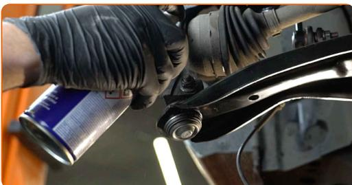
**22** Skru kugleleddets beslag af styrekuglen. Brug en kombinøgle № 13. Brug en topnøgle №15. Brug en vridenøgle.
