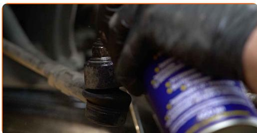
**25** Skru møtrikken af der fastgør enden til styrekuglen. Brug en topnøgle №18. Brug en skraldenøgle.
