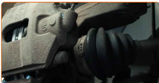
**20** Monter bremsekaliberens holdefjeder.
