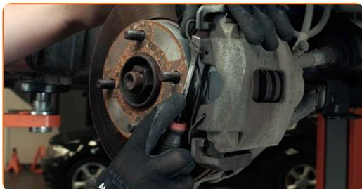
**11** Fjern bremsekaliberen.
