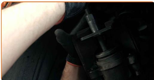
**15** Rens bremsekaliberens beslag for skidt og støv. Brug en stålbørste. Brug bremserens.
