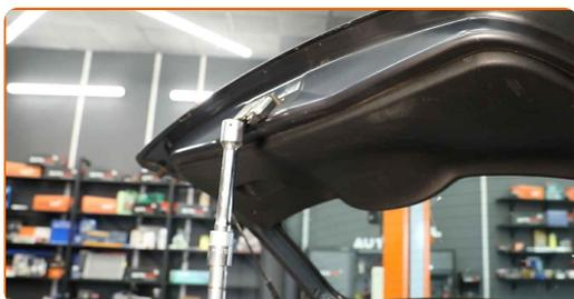
**3** Frigør låseringen der forbinder gasfjederen til bagklappen. Brug en skruetrækker med lige kærv.
