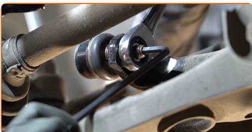
**12** Spænd befæstigelsen til der forbinder forbindelsesstangen med fjederbenet. Brug en topnøgle №15. Brug en momentnøgle. Stram den til 48 Nm moment.
