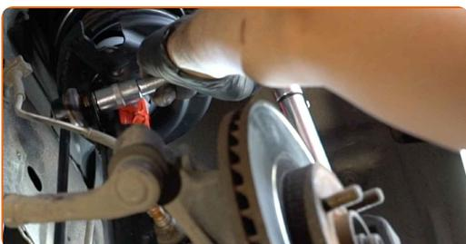
**13** Spænd befæstigelsen til der forbinder forbindelsesstangen med krængningsstabilisatoren. Brug en topnøgle №15. Brug en momentnøgle. Stram den til 48 Nm moment.
