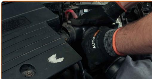
**4** Frigør luftindsugningsslanguens klemmer. Brug spændebåndstænger.
