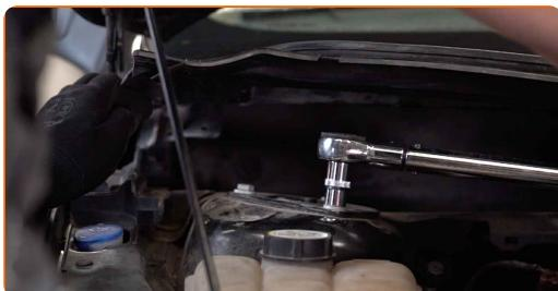
**52** Rengør monteringssædet på kølergrillen. Brug WD-40 spray.
