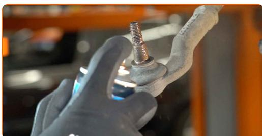
**49** Forbind forbindelsesstangen til styrekuglen.
