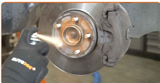
**67** Rengør bremseskivens overflade. Brug bremsrens.
