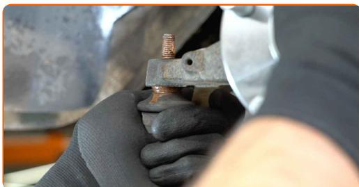
**50** Skru befæstigelses møtrikken ind som forbinder styrekuglen med styrespindel. Brug en topnøgle N°15. Brug en skraldenøgle.
