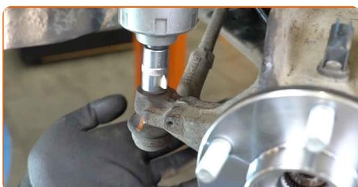
**51** Stram møtrikken der forbinder forbindelsesstangen og styrespindlen. Brug en topnøgle N°15. Brug en momentnøgle. Stram den til 48 Nm moment.
