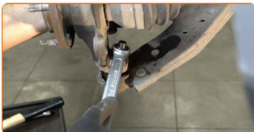
**30** Tag kugleledet af styrekuglen. Brug en lejeaftrækker.
