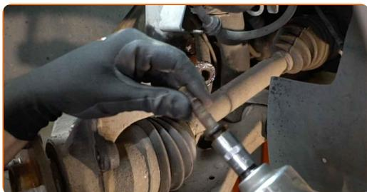
**28** Rengør befæstigelsen der forbinder kugleledet med styrespindlen. Brug en stålborste. Brug WD-40 spray.
