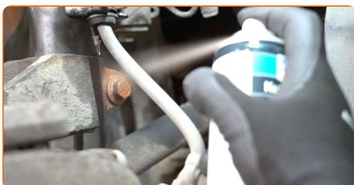
**66** Behandle overfladen hvor bremseeskiven har kontaktflade til hjulnavet. Brug kobberfedt.
