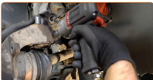
**47** Skru befæstigelsen der forbinder kugleledet til styrespindlen. Brug en kombinøgle № 21.
