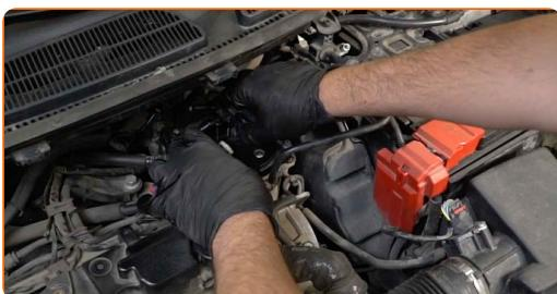
Udskiftning: brændstoffilter – FORD FOCUS III Kasse/hatchback. AUTODOC eksperter anbefaler:
