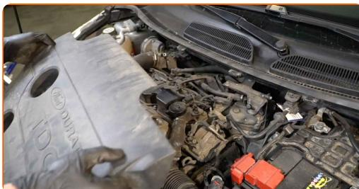
Udskiftning: brændststoffilter – FORD FOCUS III Kasse/hatchback. Råd fra AUTODOC:
