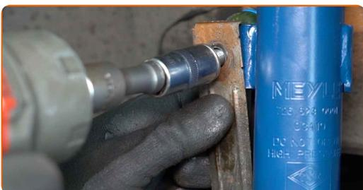
**73** Spænd befæstigelsen til der forbinder forbindelsesstangen med fjederbenet. Brug en topnøgle N°15. Brug en momentnøgle. Stram den til 50 Nm moment.
