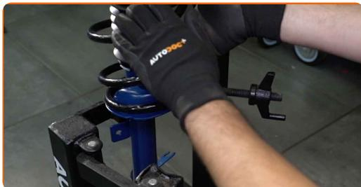
**51** Rengør montagestedet til fjederbenet. Brug en stålbørste. Brug WD-40 spray.
