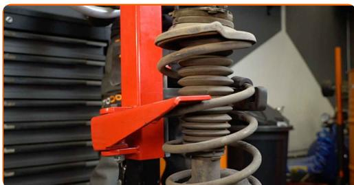
**35** Behandl fjederbenets stang. Brug en stålbørste. Brug WD-40 spray.
