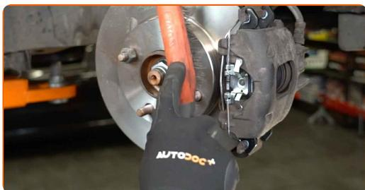
**77** Behandle overfladen hvor bremseskiven har kontaktflade til hjulnavet. Brug kobberfedt.
