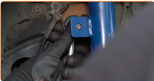
**72** Spænd stabiliseringsstiverens fastgørelse til. Brug en kombinøgle N° 15. Brug en topnøgle N°15. Brug en skraldenøgle.
