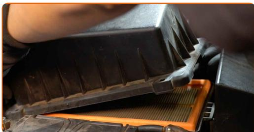
**5** Fjern filterelementet fra filterhuset.
