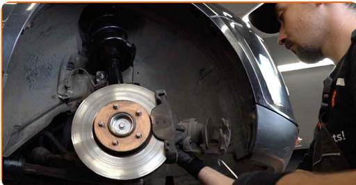
**Udskiftning: bremseklodser – FORD Focus Mk3 Hatchback (DYB). AUTODOC anbefaler:**
