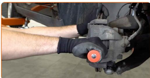
8 Løsgør bremsekaliber låsefjeder. Brug et koben.
