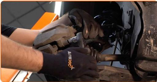
11 Fjern bremsekaliberen.
