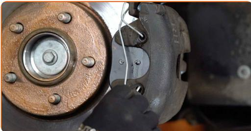
Udskiftning: bremseklodser – FORD Focus Mk3 Hatchback (DYB). Råd fra AUTODOC eksperter:
