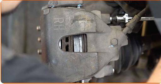
18 Monter støvhætter på bremsekaliberens styretapper.
