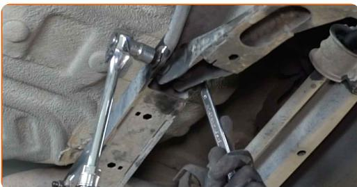
**12** Støt armen. Brug en hydraulisk løfteenhed.
