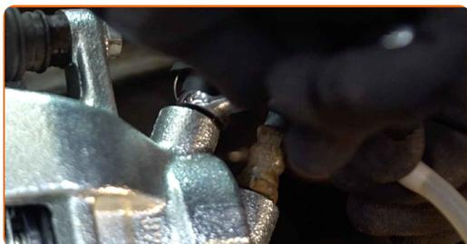
**35** Dræn bremsekaliber systemet. Tryk på bremsepedalen flere gange, indtil du kan mærke en betydelig modstand, uden at starte motoren.
