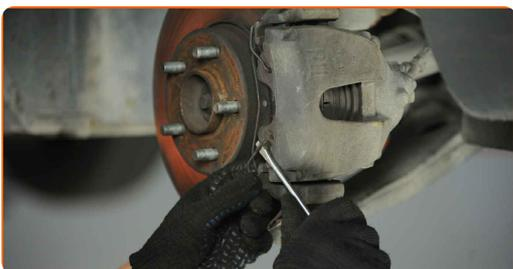
**8** Fjern støvhætter på bremsekaliberens styretapper. Brug en skruetrækker med lige kær.
