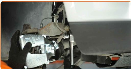
**30** Monter støvhætter på bremsekaliberens styretapper.
