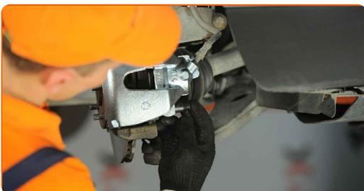
**31** Rengør bremsekaliber overfladen.
