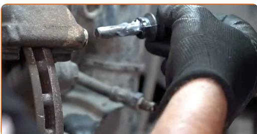
**29** Stram bremsekaliber befæstigelse. Brug HEX nr. H7. Brug en momentnøgle. Stram den til 30 Nm moment.
