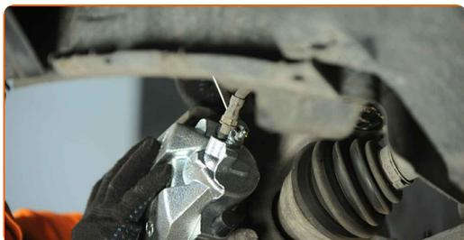
**37** Afbryd bremse udluftningssættet.
