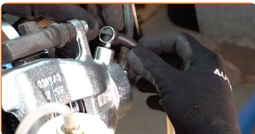
**34** Løsen bremseudluftningsskruen. Brug en kombinøgle N° 9.
