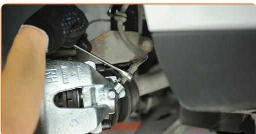
**33** Forbind bremse udluftningssættet til bremseudluftningsskuen.
