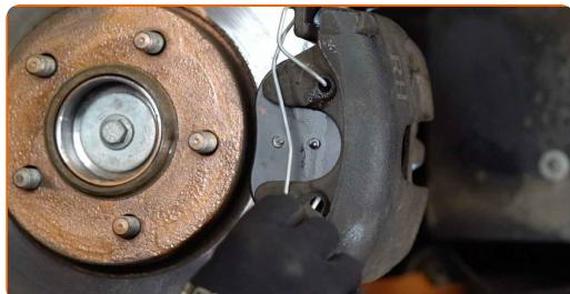
**Udskiftning: bremseklodser – FORD Kuga Mk1 SUV. Råd fra AUTODOC eksperter:**
