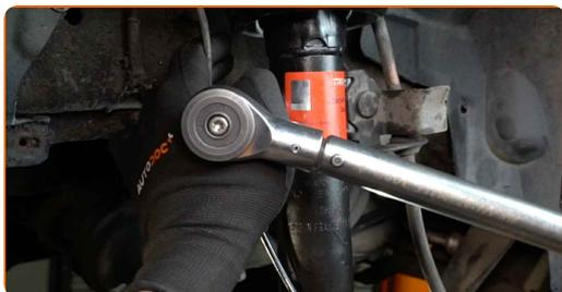
**14** Spænd befæstigelsen til der forbinder forbindelsesstangen med krængningsstabilisatoren. Brug en kombinøgle N° 17. Brug en topnøgle N°17. Brug en momentnøgle. Stram den til 48 Nm moment.
