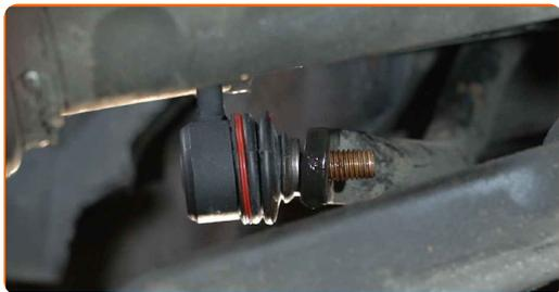
**12** Spænd stabiliseringsstiverens fastgørelse til. Brug en kombinøgle N° 17. Brug en topnøgle N°17. Brug en skraldenøgle.
