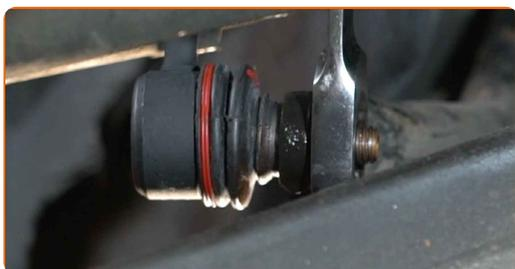
**13** Spænd befæstigelsen til der forbinder forbindelsesstangen med fjederbenet. Brug en kombinøgle N° 17. Brug en topnøgle N°17. Brug en momentnøgle. Stram den til 48 Nm moment.
