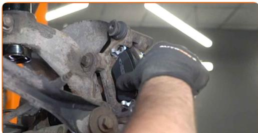
**26** Behandl bremsekaliber cylinder. Brug en nylon rengøringsbørste. Brug bremserens.
