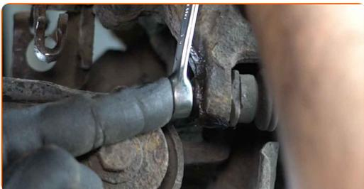
**11** Fjern bremsekaliberen. Brug et koben.
