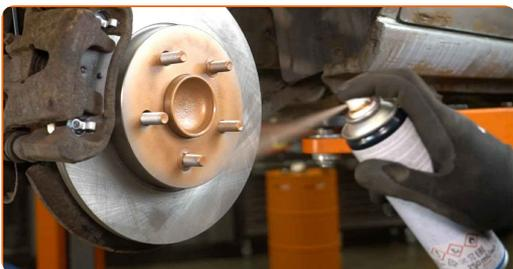
**31** Rengør bremseskivens overflade. Brug bremsrens.
