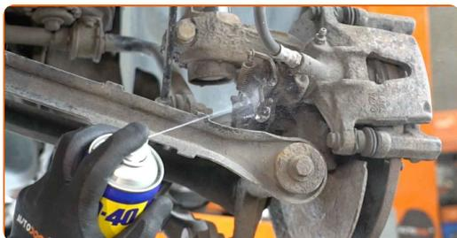
**8** Frigør parkeringsbremsekablet. Brug tænger. Brug et koben.
