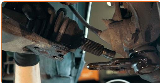
**28** Støt styrekuglen. Brug en hydraulisk løfteenhed.
