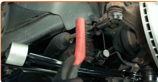
**8** Skru møtrikken af der fastgør enden til styrekuglen. Brug en topnøgle N°15. Brug en skraldenøgle.
