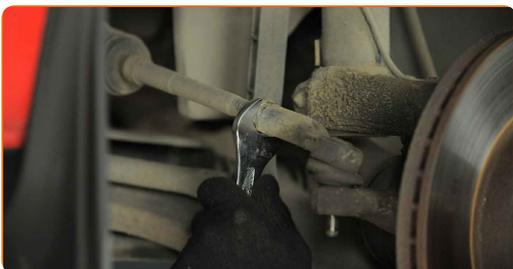
**11** Tag sporingstangens ende af styrekuglen. Brug en lejeaftrækker.
