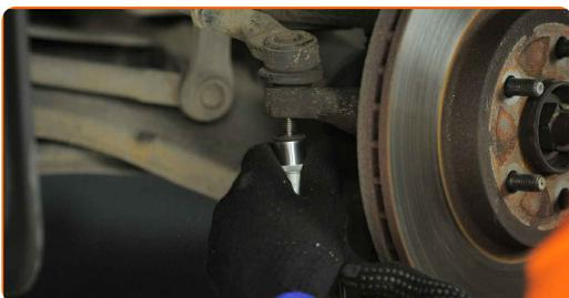
**9** Rengør styrestangens tilspændings låsemøtrik der forbinder styrestangen med styrekuglen. Brug en stålbørste. Brug WD-40 spray.
