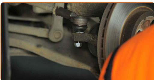
**17** Behandel befæstigelsen der forbinder forbindelsesstangen og styrespindlen. Brug kobberfedt.
