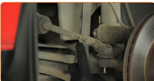
**10** Løsn låsemøtrikken der fastgør sprogingsstangen ende til sprogingsstangen. Brug en kombinøgle N° 24.
