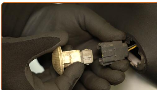
**3** Behandl stikket til blinklyset. Brug elektronikspray.
