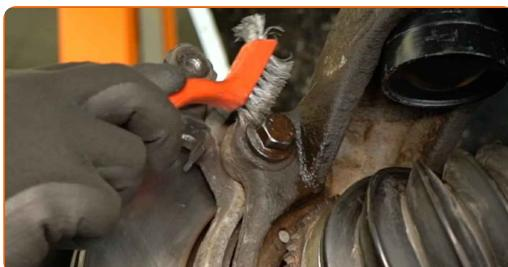
**27** Skru fastgørelserne til bremsekaliberens beslag af. Brug en 18 mm topnøgle. Brug en hjulnøgle.
