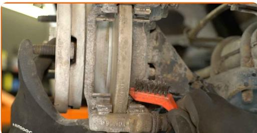
Udskiftning: bremseklodser – FORD Transit Mk6 Ladvogn / Chassis (V347, V348). AUTODOC anbefaler:
