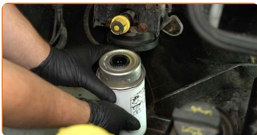
**7** Monter det nye filter, og sæt det fast i monteringsædet.
