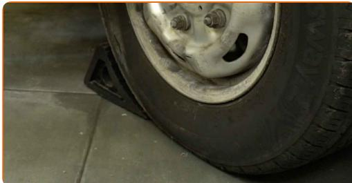
2 Løsn hjulmøtrikkerne. Brug en 21 mm slagtop. Brug en hjulnøgle.
