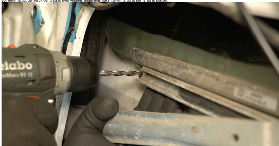
14 Bor nitterne ud, der forbinder vinduesreguleringsmekanismen med døren. Brug et bor. Brug et borsæt.
