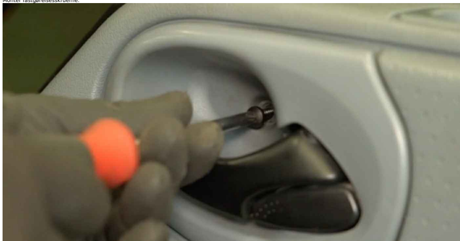
42 Stram dørpanelets fastgørelseselementer. Brug en stjerneskruetrækker.
