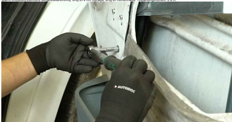
26 Monter nitterne, der forbinder glasset med vinduesreguleringsmekanismen. Brug en nittepistol. Brug nitker.
