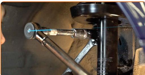
**37** Behandel fjederbenets befæstigelse. Behandle alle samlinger af krængningsstabilisatoren. Brug kobberfedt.
