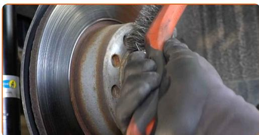
**47** Behandle overfladen hvor bremseskiven har kontaktflade til hjulnavet. Brug keramisk fedt.
