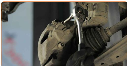
**32** Monter støvhætter på bremsekaliberens styretapper.
