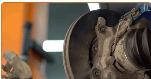
**18** Rengør bremsekive befæstigelse. Brug en stålbørste. Brug WD-40 spray.
