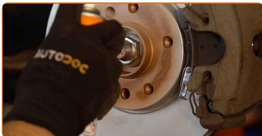
**35** Rengør bremseskivens overflade. Brug bremsrens.
