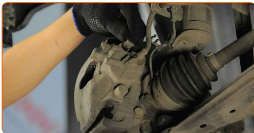
**33** Monter bremsekaliberens holdefjeder. Brug en skruetrækker med lige kær. Brug tænger.
