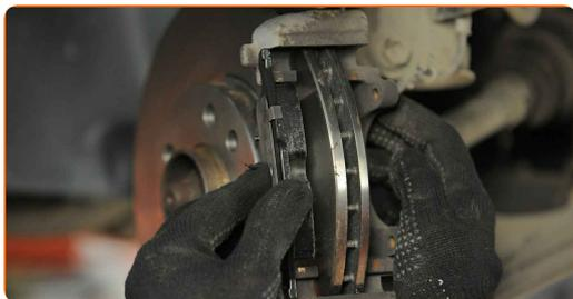
**31.1** Monter bremsekaliberen og sæt den fast.
