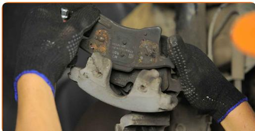
**14** Rengør bremsekaliberen befæstigelse. Brug en stålbørste. Brug WD-40 spray.
