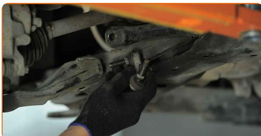
**10** Rengør montagestedet til stabilisatorstangen. Brug en stålbørste. Brug WD-40 spray.
