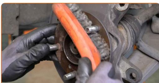
**25** Behandel kontaktfladen. Brug keramisk fedt.
