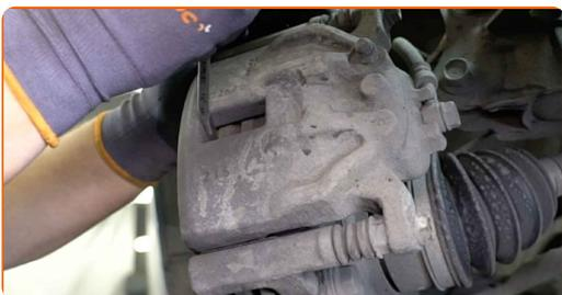
11 Rengør bremsekaliberens fastgørelser. Brug en stålbørste. Brug WD-40 spray.
