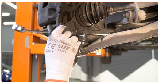
**12** Tag den nedre arm af styrekuglen. Brug en lejeaftrækker.
