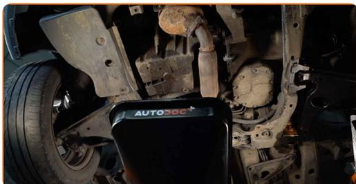
3 Rengør området omkring udtømningshullet på oliesump. Brug en stålbørste. Brug universal rengøringsmiddel.
