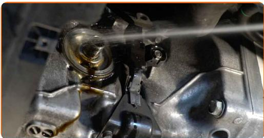
12 Skru det nye filterhus på. Brug 65/14-F spændenøgle. Bemærk det anbefalede drejningsmoment.
