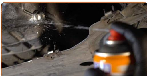
9 Løsne oliefilter. Brug 65/14-F spændenøgle. Brug en skraldenøgle.
