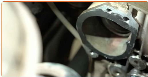
**57** Behandel vandpumpens montagested. Brug en forsegl. (Sealant)
