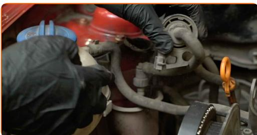
**32** Skru den øvre befæstigelse af motorbeslaget af. Brug en kombinøgle № 16. Brug en topnøgle №16. Brug en skraldenøgle.
