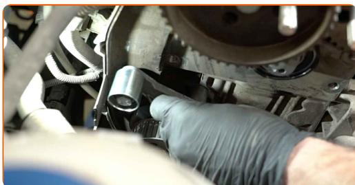
**72** Stram tandrem løbehjuls beslaget til med den integreret remskive. Brug en topnøgle N°16. Brug en momentnøgle. Stram den til 50 Nm moment.
