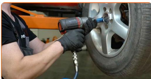
**24** Sænk bilen og stram hjulboltene på kryds med. Brug hjul slagnøgle #17. Brug en momentnøgle. Stram den til 120 Nm moment.
