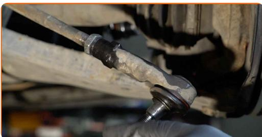
**12** Rengør montagestedet til styrekuglen. Brug en stålbørste. Brug WD-40 spray.
