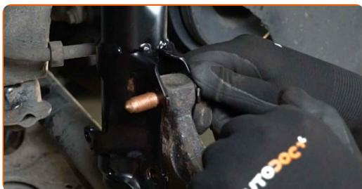
**36** Skru befæstigelse ind der forbinder fjederbenet med styrespindlen. Brug en kombinøgle N° 18. Brug en topnøgle N°18. Brug en vridenøgle.
