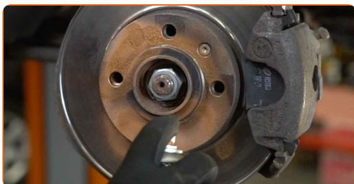
**45** Rengør bremseskivens overflade. Brug bremsrens.
