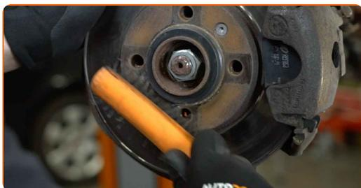
**44** Behandle overfladen hvor bremseskiven har kontaktflade til hjulnavet. Brug kobberfedt.
