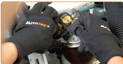
**15** Skru fastgørelsen af der forbinder brændstof forsyningslinien til brændstoffilterhuset. Brug en topnøgle N°7. Brug en skraldenøgle.
