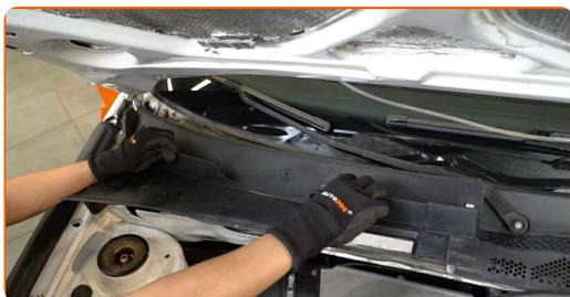
**11** Geninstaller kabinfilterhusets forsegling.
