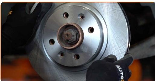
**15** Stram bremseskivens skruer. Brug Torx T30. Brug en momentnøgle. Stram den til 14 Nm moment.
