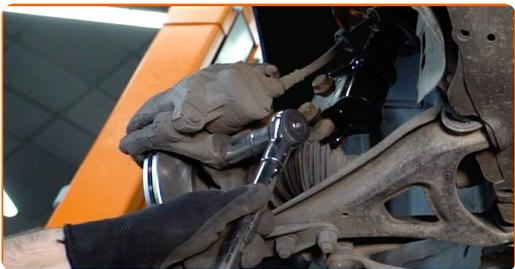
**18** Behandle overfladen hvor bremseeskiven har kontaktflade til hjulnavet. Brug kobberfedt.
