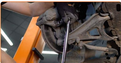
**10** Fjern bremsekaliberen sammen med bremseåget.
