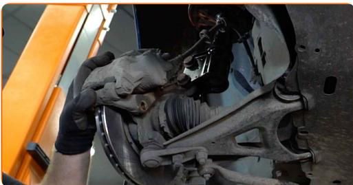
**17** Stram bremsekaliberens beslag. Brug en topnøgle №18. Brug en momentnøgle. Stram den til 100 Nm moment.
