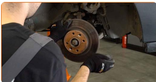
**13** Rengør navet. Brug en stålbørste. Behandl kontaktfladen. Brug kobberfedt.
