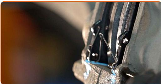
28 Installer bremseklodsernes låseclips.
