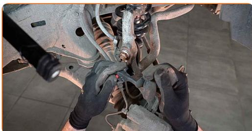
**15** Rengør bremsekaliberens fastgørelser. Brug en stålbørste. Brug WD-40 spray.
