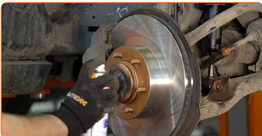
30 Rengør bremseskivens overflade. Brug bremserens.
