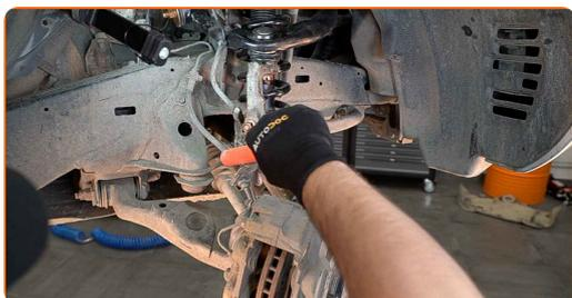
**14** Tag bremseslangens monteringsbeslag af. Brug en topnøgle N°12. Brug en skraldenøgle.
