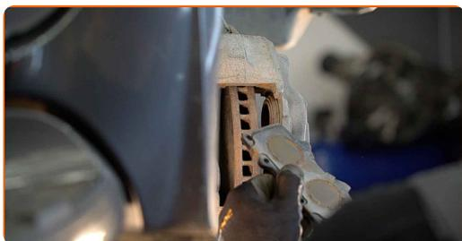
**13** Rengør bremseslange beslagets befæstigelse. Brug en stålbørste. Brug WD-40 spray.
