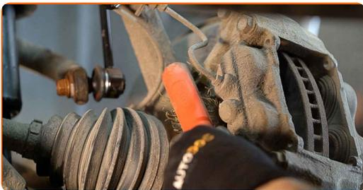
**16** Skru kaliberens skruer af. Brug en topnøgle N°17. Brug en vridenøgle.
