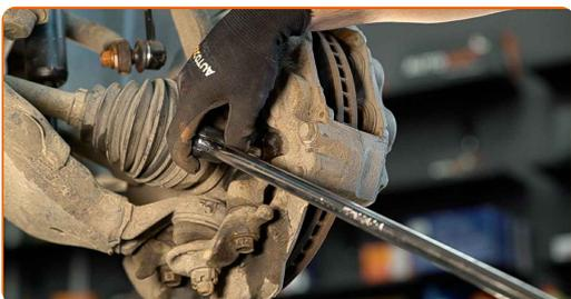
**17** Fjern bremsekaliberen.
