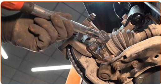
**27** Behandel bremsekaliber cylinder. Brug en nylon rengøringsbørste. Brug bremserens.
