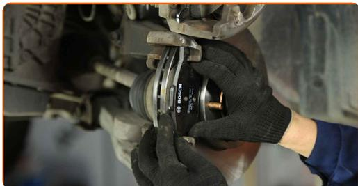
**30** Monter bremsekaliberen og sæt den fast.
