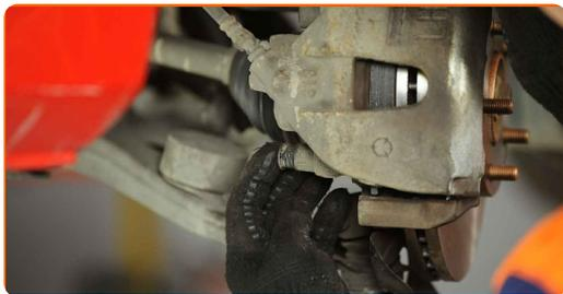
**36** Monter bremsekaliberens holdefjeder. Brug rundtænger. Brug en skruetrækker med lige kærve.
