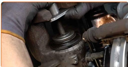
**19** Monter bremsekaliberen og sæt den fast.
