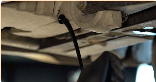
**Udskiftning: olie og oliefilter – MERCEDES-BENZ C-klasse T-modell (S202).**
