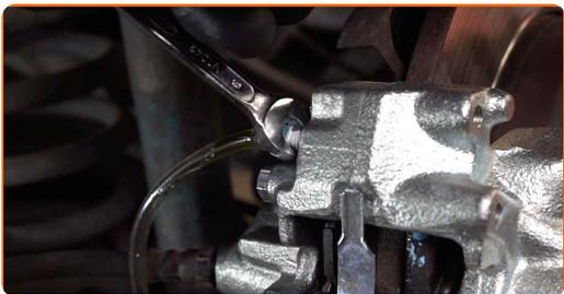
**34** Afbryd bremse udluftningssettet.
