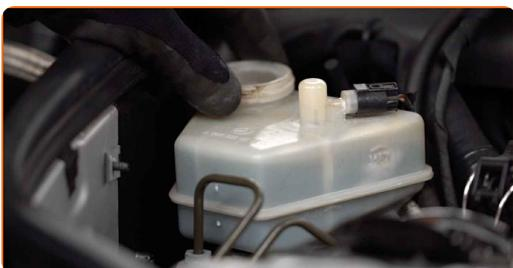
**31** Tryk på bremsepedalen flere gange, indtil du kan mærke en betydelig modstand, uden at starte motoren.
