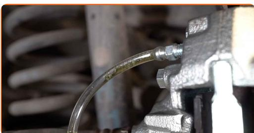
**33** Stram bremseudluftningsskruen til. Brug en kombinøgle № 9.
