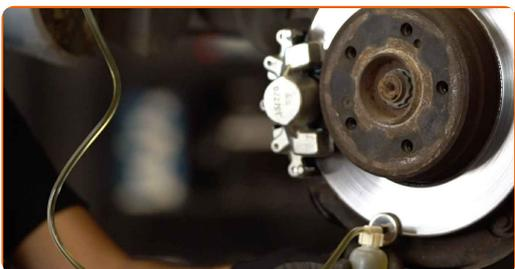
**35** Rengør bremsestavens overflade. Brug en stålborste. Behandl kontaktfladen. Brug kobberfedt.
