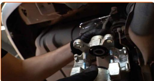
**22** Monter bremsekaliberen og sæt den fast.
