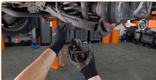
Udskiftning: bremsekaliber – MERCEDES-BENZ C-klasse T-modell (S203).
