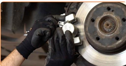
**23** Stram bremsekaliber befæstigelse. Brug en topnøgle N°16. Brug en momentnøgle. Stram den til 55 Nm moment.
