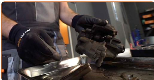
**19** Hvis de gamle bremseklodser skal bruges, så rengør dem. Brug en stålbørste. Brug bremserens.
