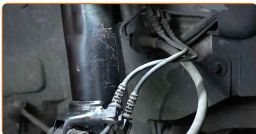
**54** Rengør montagesteder til stabilisatorstangen. Brug en stålbørste. Brug WD-40 spray.
