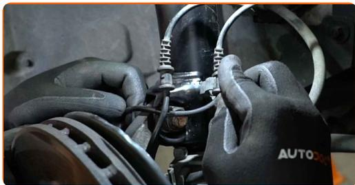
**53** Monter kablet til bremseklovs sensoren.
