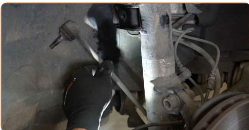
13 Tag bremseslangens monteringsbeslag af. Brug tænger.
