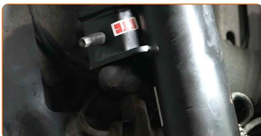
**56** Spænd befæstigelsen til der forbinder forbindelsesstangen med fjederbenet. Brug en topnøgle N°16. Brug en momentnøgle. Stram den til 60 Nm moment.
