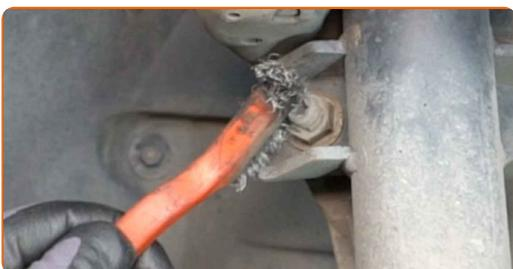
**11** Løsen befæstigelsen af forbindelsen mellem forbindelstangen og fjederbenet. Brug en topnøgle N°18. Brug en skraldenøgle.
