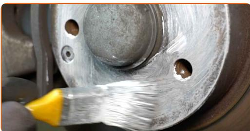
**53** Rengør bremseskivens overflade. Brug bremsrens.
