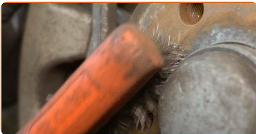
**52** Behandle overfladen hvor bremseskiven har kontaktflade til hjulnavet. Brug keramisk fedt.
