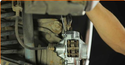
**30** Afbryd bremse udluftningssættet.
