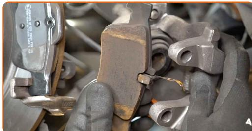
**Udskiftning: bremseklodser – MERCEDES-BENZ CLS (C218). Råd fra AUTODOC eksperter:**
