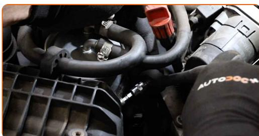
**9** Løsen klammerne på brændstoffilter rørene. Brug en topnøgle N°5.5. Brug en topnøgle N°7. Brug en skraldenøgle.
