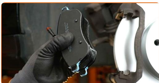
Udskiftning: bremseklodser – MERCEDES-BENZ E-klasse Cabriolet (A207).
