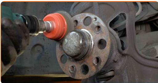
**23** Behandl kontaktfladen. Brug keramisk fedt.
