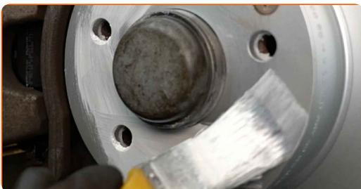
**41** Rengør bremseskivens overflade. Brug bremsrens.
